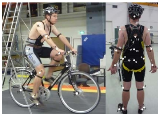
Figuur 4. Volledig geïnstrumenteerde fiets en bereider voor het observeren van de besturing van de fiets. Experimenten uitgevoerd op de lopende band van de VU Amsterdam [11].
