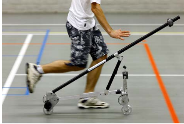
Figuur 3. Two-mass-skate bicycle, zelfstabil zonder gyros en zonder naloop [9,10].
